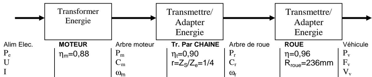
Etablir la loi d'entrée sortie entre  $\omega_m$  et  $\omega_r$ , puis entre  $\omega_r$  et  $V_v$  (en m/s)
